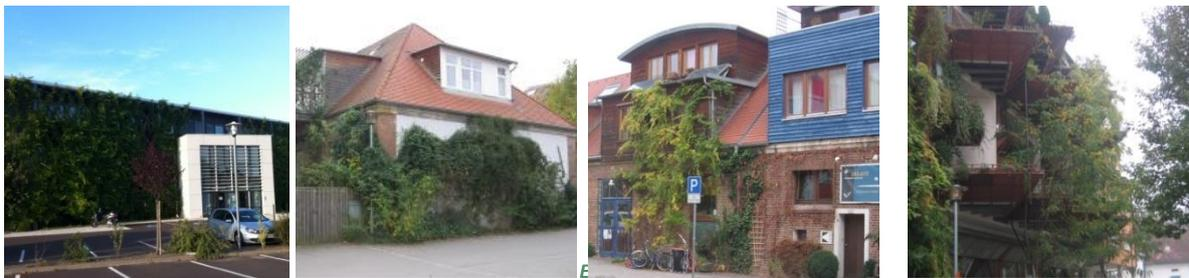
*Exemples : Mur végétalisé à partir du sol, mur végétalisé à partir de dispositif implanté sur le mur vertical, mur de soutènement permettant le développement des végétaux.*
